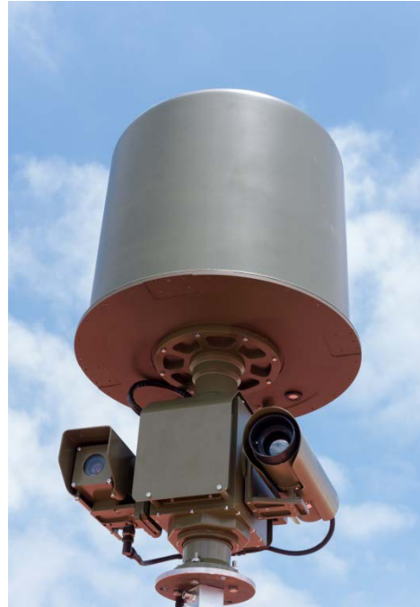
Figura I - 5. Proyecto COINCIDENTE ART. Adaptación de un radar de vigilancia superficial de alta resolución para aplicaciones de defensa (Fuente: Advanced Radar Technologies).
