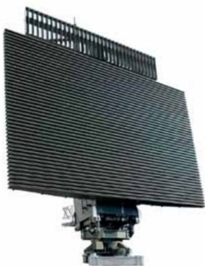
Figura III - 3. Simulación del RADAR Móvil 3D, en desarrollo a través de Compra Pública Innovadora (Fuente: INDRA)
