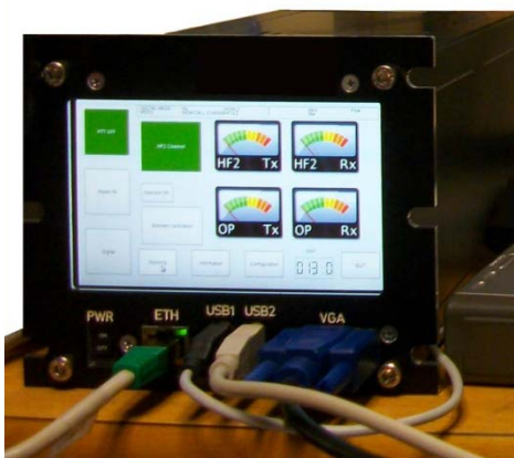
Figura I - 14. Proyecto COINCIDENTE HFDVL - Forma de onda para voz/datos en HF (Fuente: MM CICOM Telecomunicaciones S.L.).
