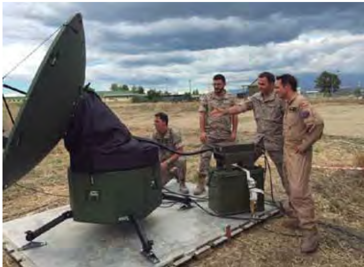
El personal del GRUMOCA en la base de Sigonella monta la antena del terminal satélite para las comunicaciones con el avión P-3 Orión.
