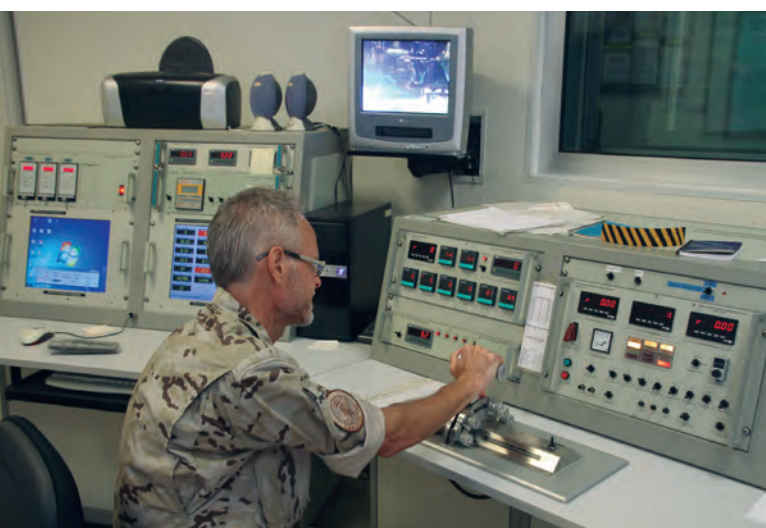
Arriba, un caza F/A-18A armado con misiles AIM-9 Sidewinder. A la derecha, los armeros montan los misiles en las puntas de las alas. A la izquierda, un mecánico maneja una turbina desde la cabina de control del banco de motores.
