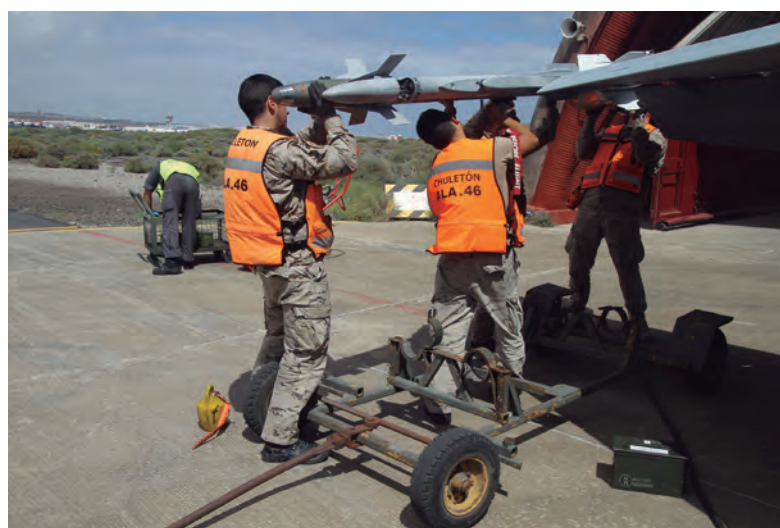
Arriba, un caza F/A-18A armado con misiles AIM-9 Sidewinder. A la derecha, los armeros montan los misiles en las puntas de las alas. A la izquierda, un mecánico maneja una turbina desde la cabina de control del banco de motores.
