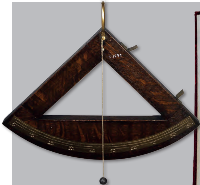
Cuadrante de plomada, realizado en madera y empleado en el viaje de Magallanes-Elcano.
