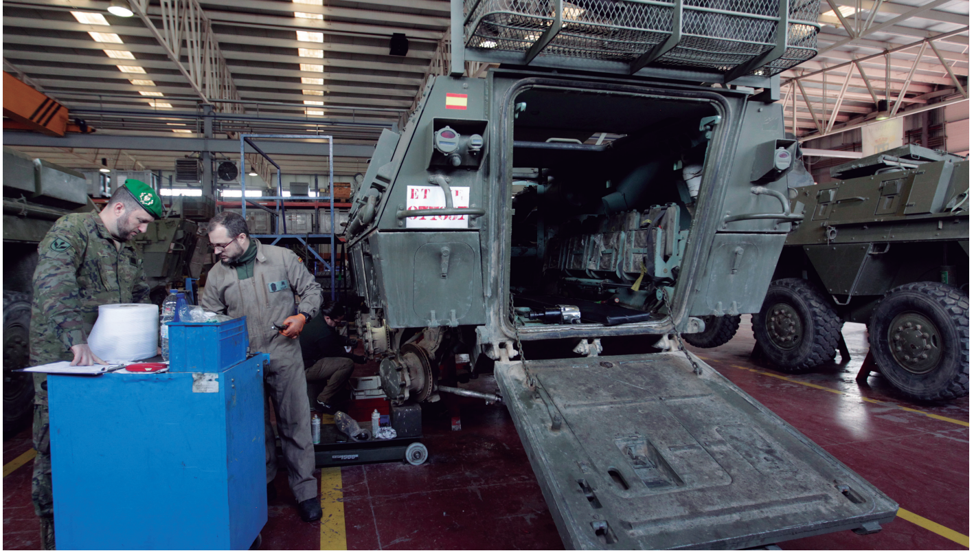
Un BMR, en el taller del Grupo de Mantenimiento de la AALOG 41. Con capacidad para reparaciones de tercer escalón, se hace cargo de los vehículos averiados durante las maniobras en San Gregorio así como de los del resto de unidades de su área de actuación.
